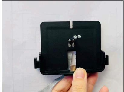
8 Colokkan konektor ke slot di bagian bawah dasar.
